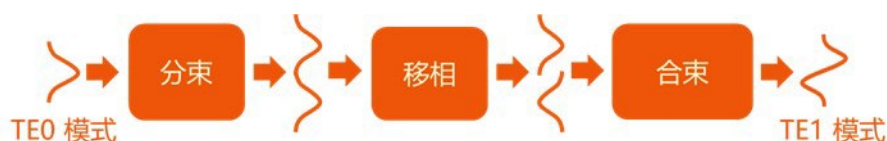
图 4.2-1 在模式转换过程中，波束塑形方法的原理示意图
