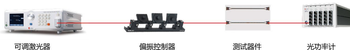
图 3.3-2 含超构材料的片上器件测试方法示意图
